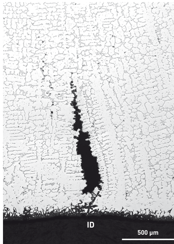
図7: クリープ割れの高倍率顕微鏡写真
